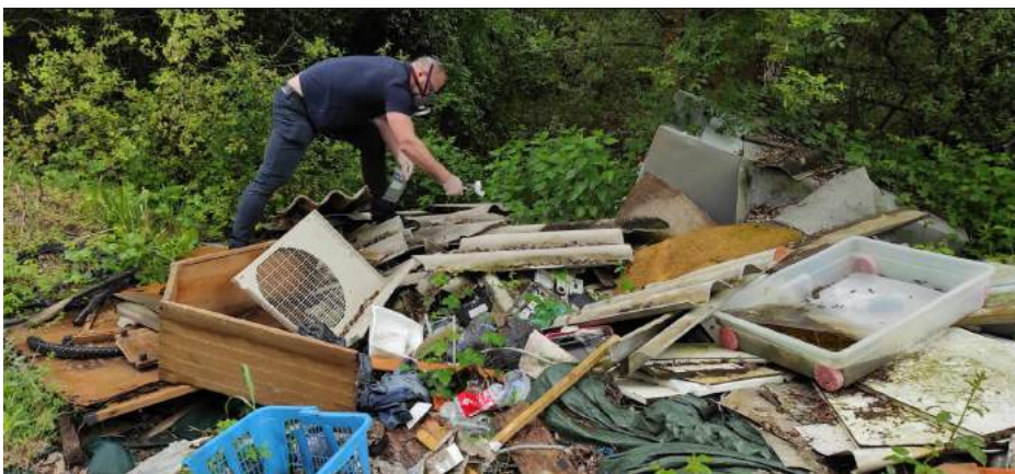
Analyse d'un dépôt contenant des fibrociments amiantés le long du chemin de la Lagune
